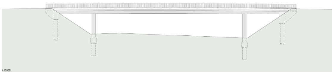
Abbildung 24: Längsschnitt und Ansicht „einstegiger Plattenbalken in Ortbeton“ / Objekt Z37 (breite Brücke)
